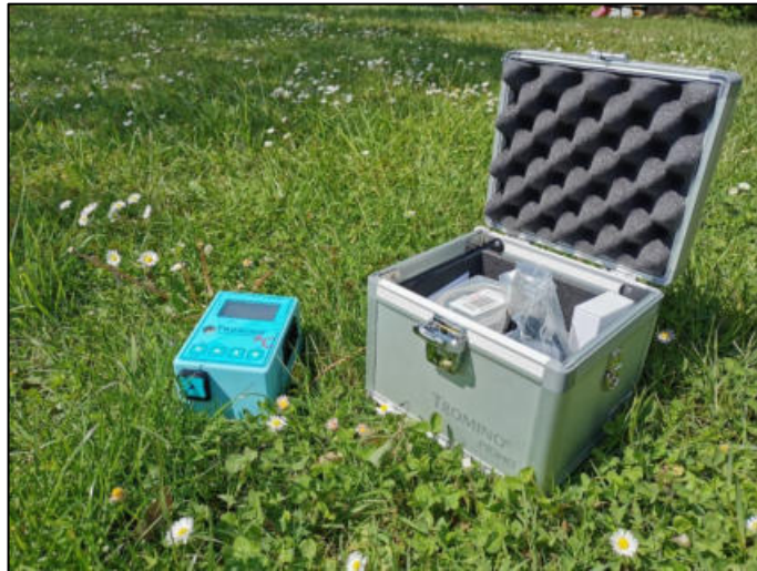
Figura 18 – Tromino Blu ® con cui sono state realizzate le misure in campo
